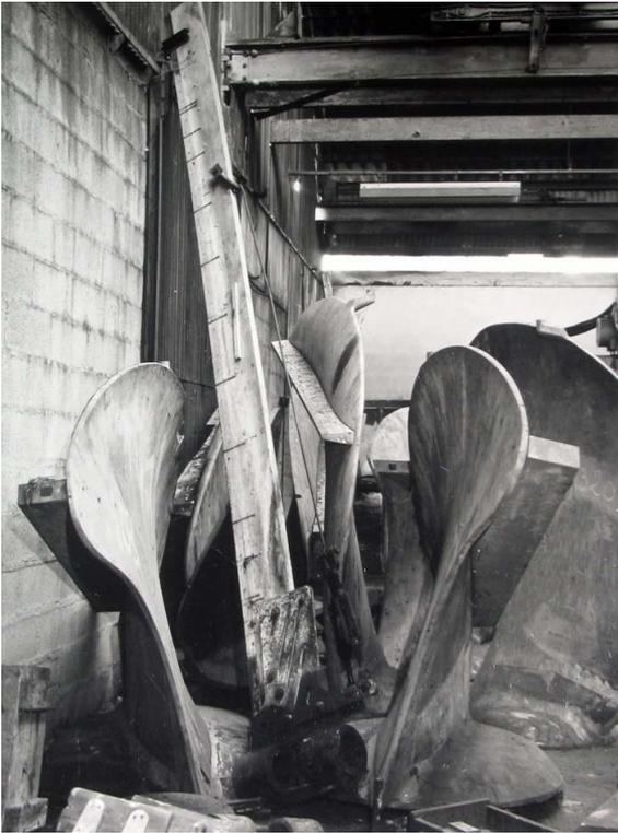
Stockage des modèles : au milieu une planche à trousser de grande dimension, difficilement lisible.
