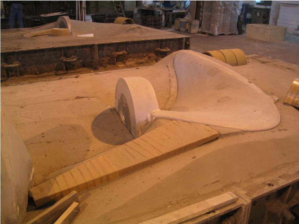
Préparation d'une coulée de pale d'hélice, *Atlantic Industrie*, Nantes Chantenay, le modèle est placé dans le sable : au premier plan, matérialisation de l'entonnoir de coulée, le vide pour la masselotte n'est pas encore mis en forme, il sera nécessaire à l'épanchement et au retrait du surplus de métal. Photo Jean-Louis Kerouanton, 2005.
